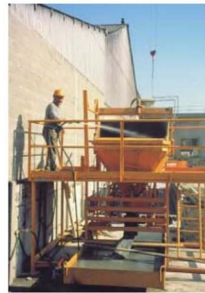
Système de récupération des laitances du béton (lycée Maximilien Perret à Alfortville - 94)
